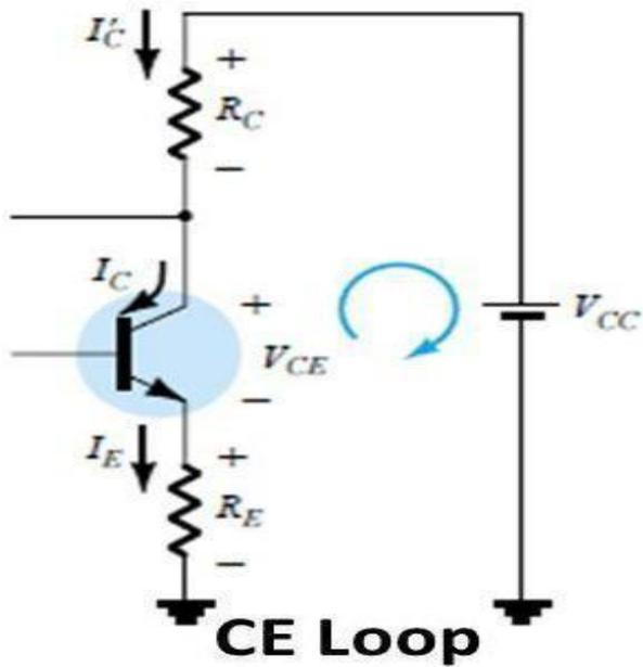
$$V_{CC} - I_C R_C - V_{CE} - I_E R_E = 0$$
