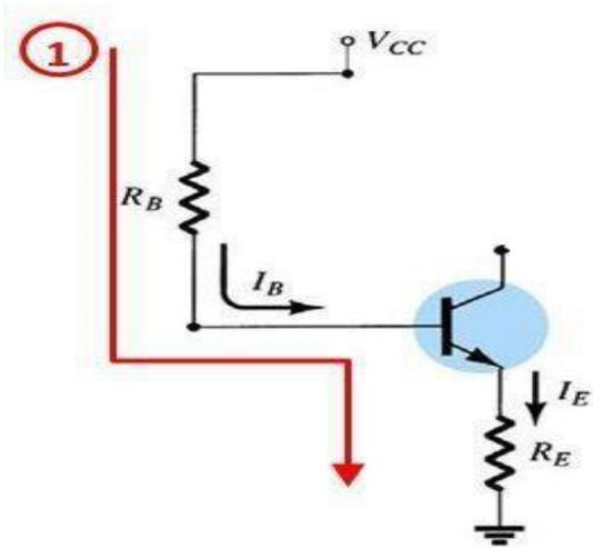
$$V_{CC} - I_B R_B - V_{BE} - I_E R_E = 0$$
