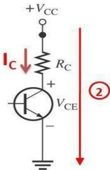
$$V_{CE} + I_C R_C - V_{CC} = 0$$
