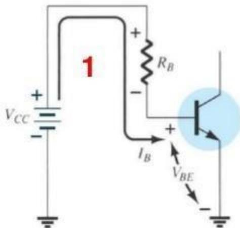
$$V_{CC} - I_B R_B - V_{BE} = 0$$
