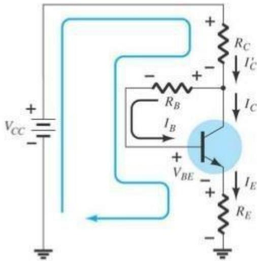
$$V_{CC} - I_C R_C - I_B R_B - V_{BE} - I_E R_E = 0$$
