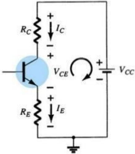
$$V_{CC} - I_C R_C - V_{CE} - I_E R_E = 0$$
